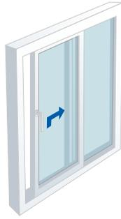
Con este principio se pueden alcanzar dimensiones de más de 3 metros de apertura de hoja. Gracias a sus herrajes especiales, destaca de este sistema la facilidad con el que la hoja se desliza con un suave empuje.
